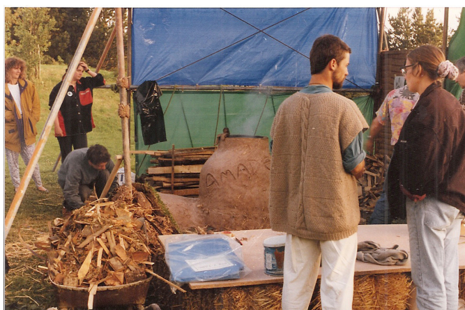
Φωτογράφια 5. Καμίνι όπου γίνεται ψήσιμο κεραμικών με αλάτι (salt firing).
