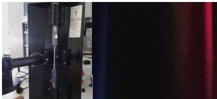
Εικόνα 1 Φως εκπεμπόμενο από μια λάμπα που περιέχει αέριο Υδρογόνο και το αντίστοιχο φάσμα του.
