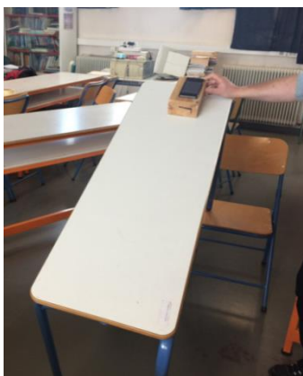
Εικόνα 18 Η πειραματική διάταξη και η μέτρηση της γωνίας \varphi του κεκλιμένου επιπέδου.
