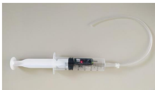
Εικόνα 3 Η σύριγγα με το Arduino και τον προσαρτημένο σωλήνα σιλικόνης
