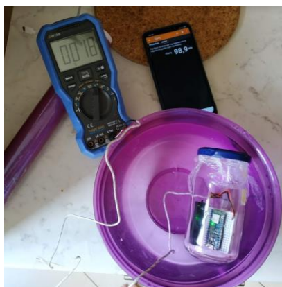
Εικόνα 2 Ισόχωρη θέρμανση αερίου με τον μικροελεγκτή στην κουζίνα
